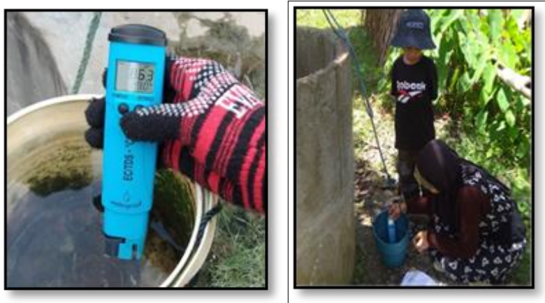
Gambar 1. Pengukuran Nilai DHL dengan alat conductivity meter
